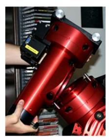
Beide Achsen sind mit Rutschkupplungen ausgestattet, wobei die Gängigkeit sehr genau mit vier Schrauben pro Achse eingestellt werden kann. Ist das GOTO eingerichtet, sollte man natürlich keinen Gebrauch davon machen.
