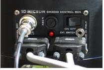
(Initialisierung, Positionierung, Trac-king...). Dadurch ist das System komplett fernsteuerbar. QCI benutzt als PC Interface das Meade LX 200 Protokoll oder die Ascom Platt-form. Die (englischsprachige) Steuersoftware PERSEUS gehört zum Lieferumfang des Komplettpaketes.
