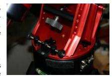
Bohrung und das als Gegenstück Stativ in der Mitte einen kleinen Zapfen. Das gewährleistet eine einfache Zentrierung auf dem Stativ. Fixiert wird die Einheit dann mit vier griffigen M6-Rändelschrauben an allen vier Seiten der Basis. Die Schrauben müssen nur ganz leicht mit zwei Fingern angezogen werden.
