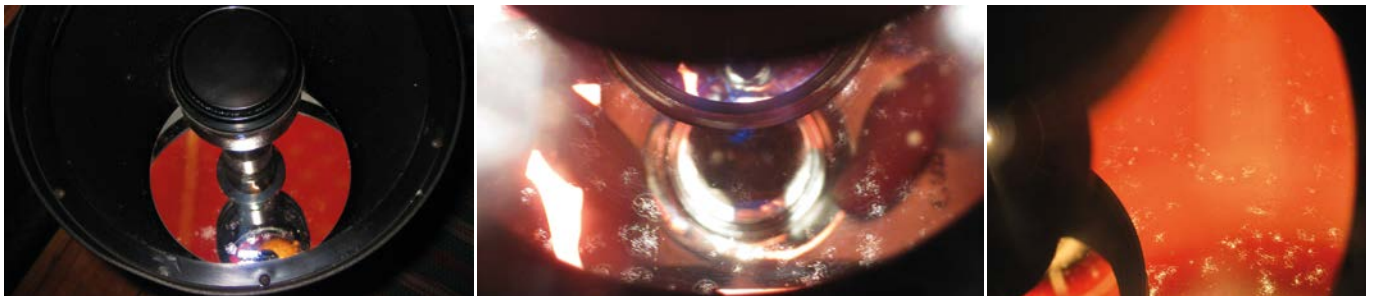
Diese Bilder zeigen den Blick in ein Schmidt-Cassegrain, das einige Jahre in feucht-warmem Klima am Meer gelagert wurde. Sogar der geschlossene Tubus eines SC konnte unter diesen Bedingungen keinen Schutz vor Pilzbefall bieten.
